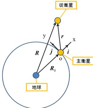
図 1 円軌道上の主衛星と従衛星
