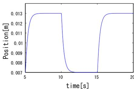
図7 66gの鋼球を浮上させる際のシミュレーション
