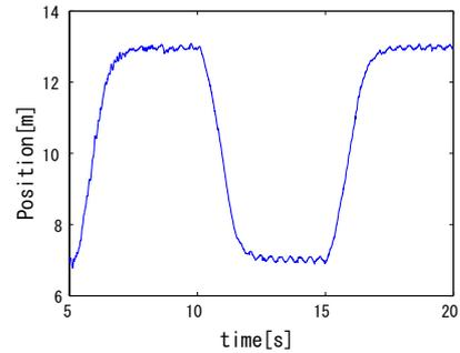
図8 45gの鋼球を浮上させる実験
