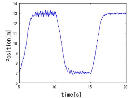
図9 45gの鋼球を浮上させる実験
