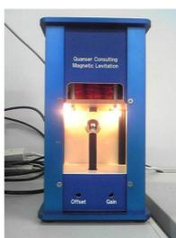
図1 磁気浮上装置
