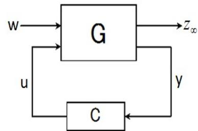
図 3 一般化制御対象: $H_\infty$  制御
