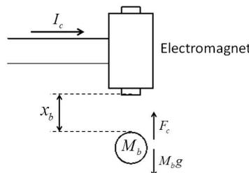
図2 磁気浮上系の構成図
