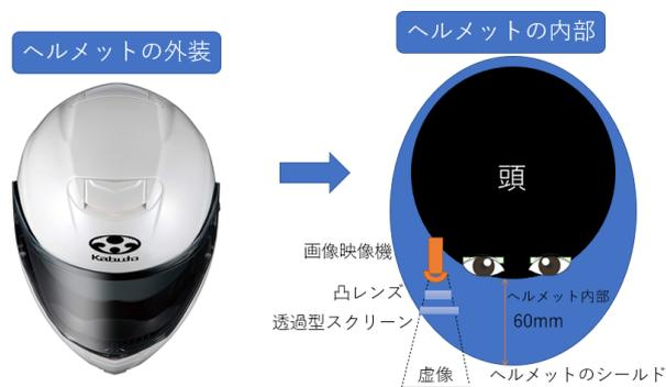
図 2 ヘルメット内部の外付け HUD 構造
