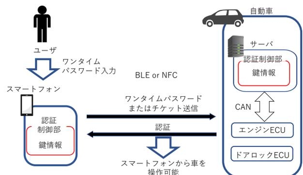
図1 車両スマートフォンキーシステム概要
