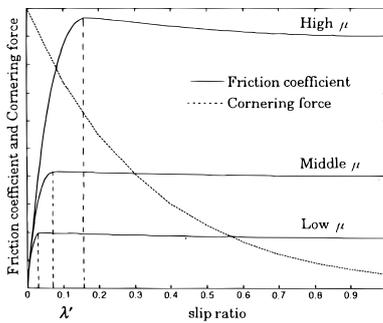
図 1 制動摩擦係数、コーナリングフォースとスリップ率の関係
