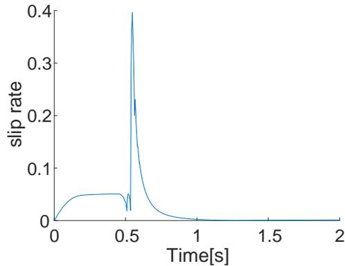
図 3 摩擦係数が約 0.6 のときのスリップ率のシミュレーションの結果
