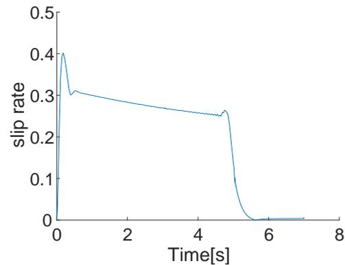
図 5 摩擦係数が約 0.1 のときのスリップ率のシミュレーションの結果
