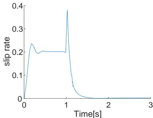
図 4 摩擦係数が約 0.4 のときのスリップ率のシミュレーションの結果
