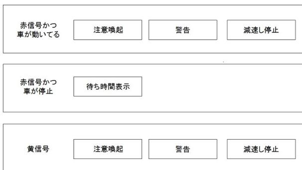
図 2 赤信号検知システム：振る舞い
