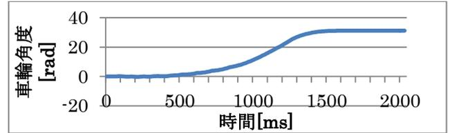
図 4.9:ファジィ制御の車輪角度の実測値
