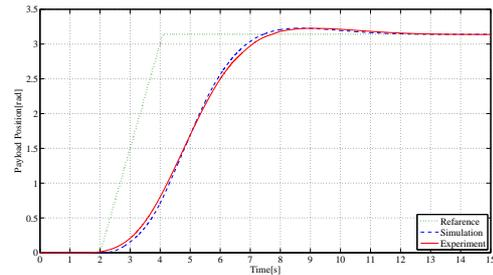
図 2 巻き上げながらの旋回シミュレーション及び実験
