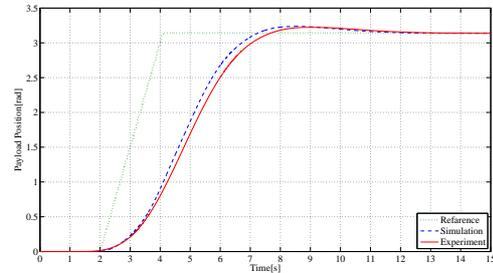
図 1  $l_{p\text{-max}}$  での旋回シミュレーション及び実験
