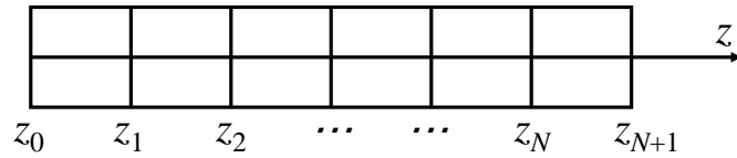
図 2 サブドメインに分割された有限長完全導体棒
