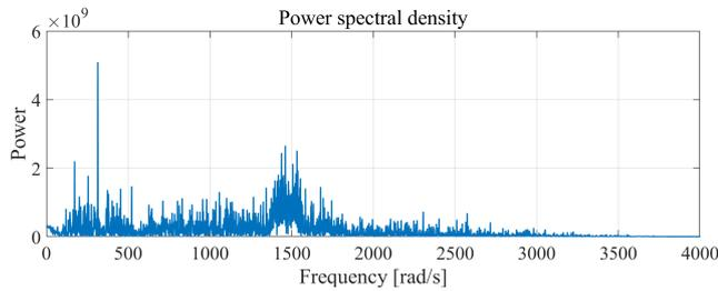
図 6 FFT analysis of  $\dot{\omega}_m$
