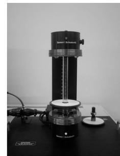
図7 磁気浮上装置
