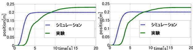
図 1  $l=0.1$  でのペイロードの位置 図 2  $l=0.3$  でのペイロードの位置
