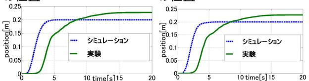
図 3  $l=0.5$  でのペイロードの位置 図 4  $l=0.7$  でのペイロードの位置
