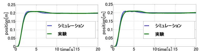
図 6  $l=0.1$  でのペイロードの位置 図 7  $l=0.3$  でのペイロードの位置
