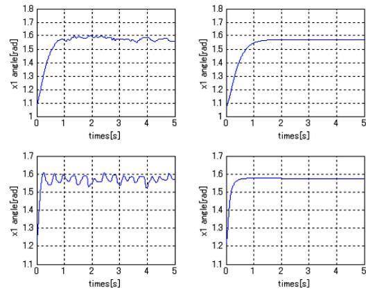
図 2: 安定化実験(左)とシミュレーション(右)．(上段: 4次元システム系 下段: 5次元システム系)
