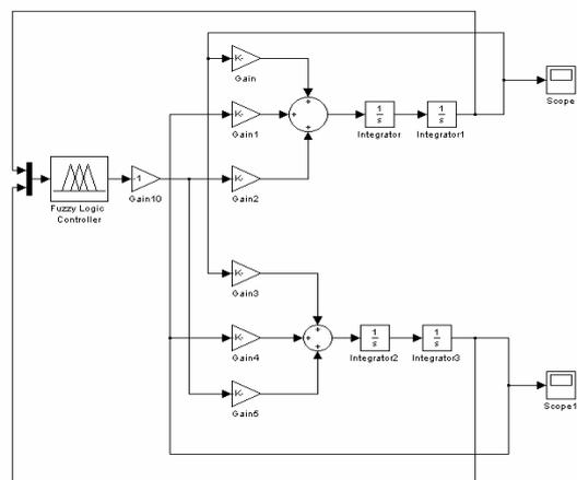
図3  $\theta$  と  $x$  の 2 入力によるブロック線図
