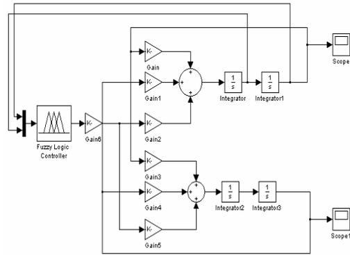
図5  $\theta$ と $\dot{\theta}$ の2入力によるブロック全図
