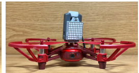
図 3: 向きを変えた赤外線センサ
