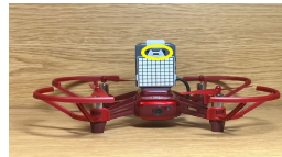
図 2: 当初の赤外線センサ
