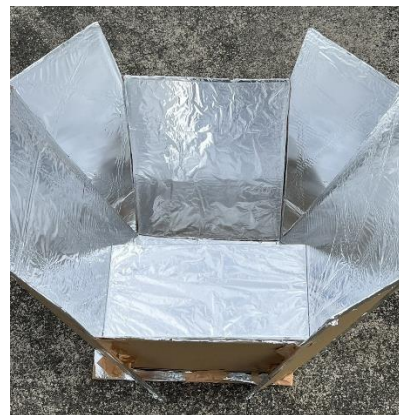
図 1 作製したテルケス型ソーラークッカー
