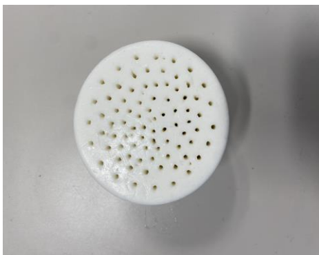
図5 規則的に穴を開けたファントム
