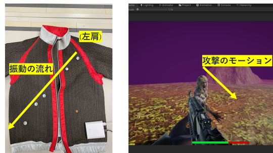
(a)触覚呈示 (b)画面上 ゾンビの攻撃に合わせてジャケットに分布している触覚呈示素子を振動させる
