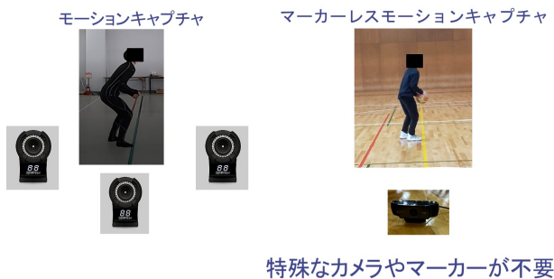
図2 深度センサー, 光学式モーションキャプチャとマーカーレスモーションキャプチャの差異
