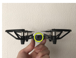
図 2 Tello 搭載のカメラ
