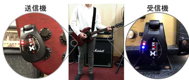
図1 ワイヤレスシステム使用時の概略図
