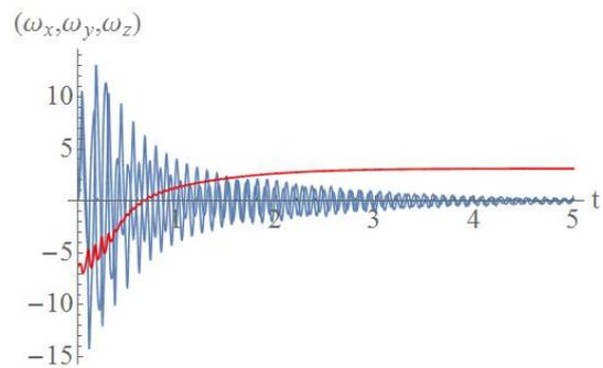
図4 動摩擦係数  $\mu_1 = 0.1$  のときの  $\omega_x, \omega_y, \omega_z$
