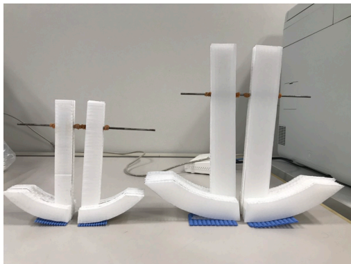
図 5 プラダンで製作した 1.5 倍の大きさの受動歩行機 (右)
