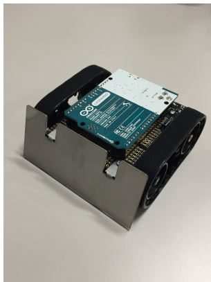
図1 Arduinoを搭載したZumo
