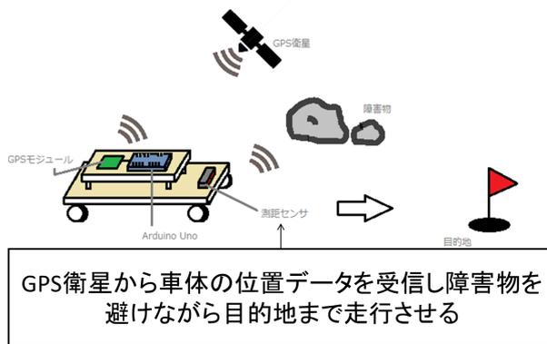
図7 本研究のロボットカーの動作図
