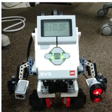
図 1 EV3 を利用して作成した二輪駆動型倒立振子
