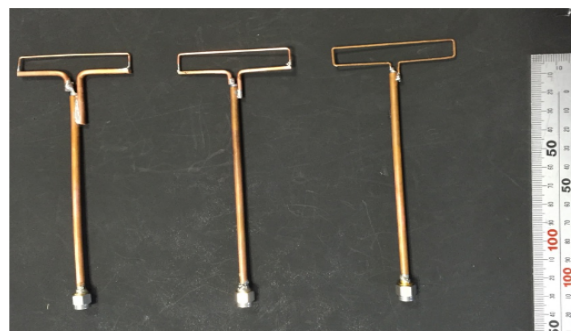
図 7 3 本の折り返しダイポールアンテナ
